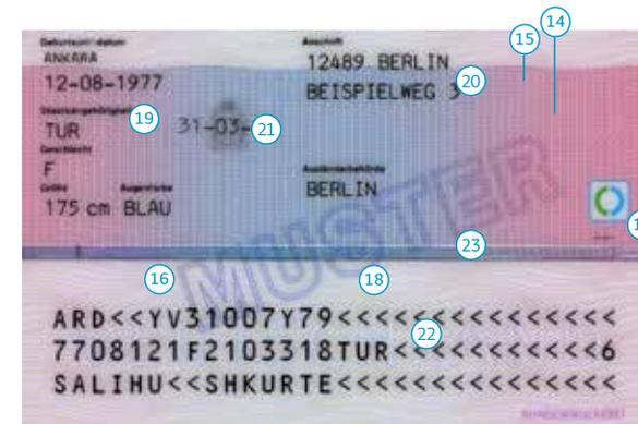
dargestellt und sicher in das Material der Karte integriert. Mit der gleichen Technik wird die alphanumerische Seriennummer (in OCR-B-Schrift) eingesetzt.
