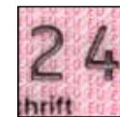
**13 Taktile Merkmale.** Die sechsstellige Kartenzugangsnummer auf der Vorderseite des elektronischen Aufenthaltstitels wird per Lasergravur als fühlbare Schrift aufgebracht.
